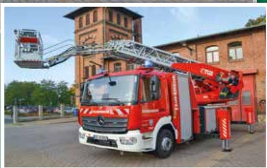
Außerdem erfolgte die Übergabe der neuen Drehleiter, die vom Land Sachsen-Anhalt mit 180.000 Euro gefördert wurde. Die Drehleiter kann bis zu 30 Meter ausfahren und besitzt ein Knickgelenk, mit dem man besser über einen Dachfirst kommt und somit besser löschen und retten kann. Das Fahrzeug mit einem Gestell von Mercedes Benz hat einen Gesamtwert in Höhe von 586.000 Euro. Wir freuen uns und danken allen Beteiligten, die beide Fahrzeuge ermöglicht haben.
